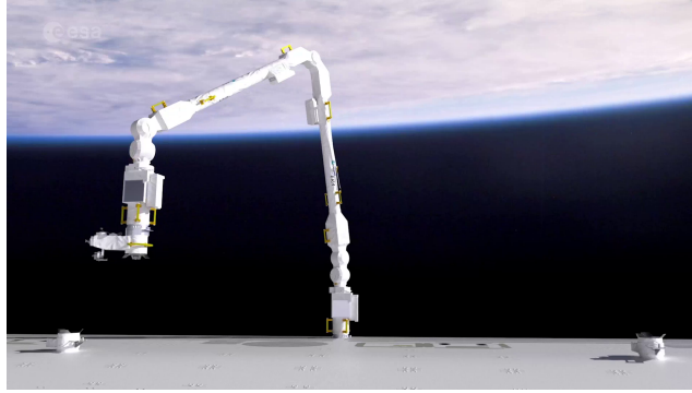
Figur 7: European Robotic Arm, som sedan 2021 finns på ISS, och som i denna tentamen modelleras med G_P(s) i uppgift 6. Bild från European Space Agency.
